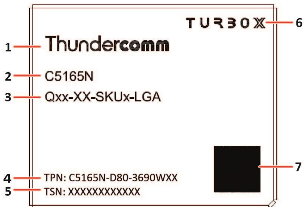
Figure 1-6. Laser Marking of C5165N SOM
